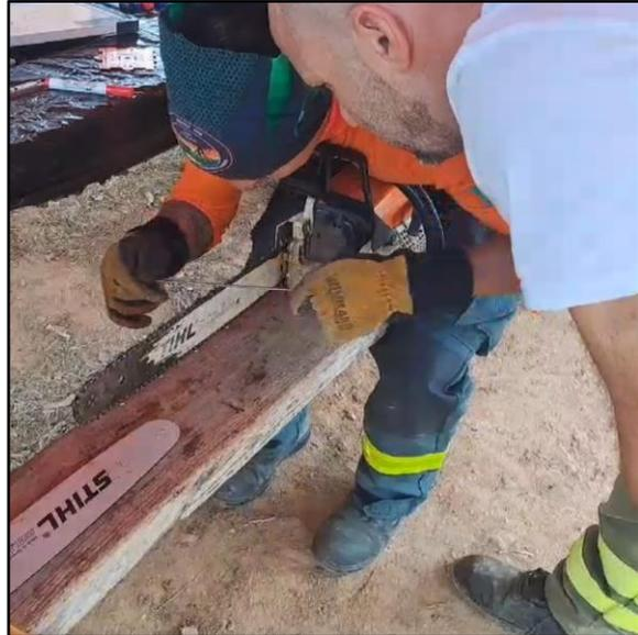
Ilustración 31: Estación mantenimiento de la motosierra.
